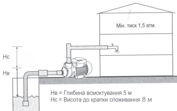
Мал. 1. Типові схеми водопостачання з використанням відцентрового поверхневого насоса.
