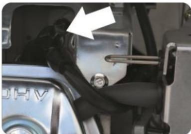
Свеча зажигания: эквивалент TORCH F6TC.
