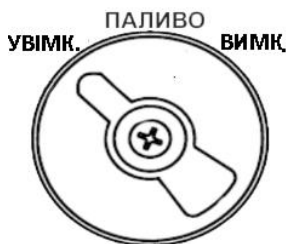
Рисунок 12. Схема відкриття паливного крана.
