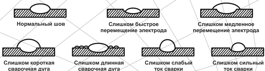
Рисунок 6. Основные виды ошибок при сварке полуавтоматом.
