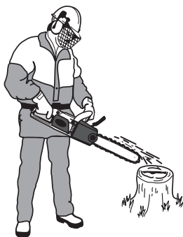
Рисунок. 7. Перевірка працездатності системи змащення напрямної та ланцюга
