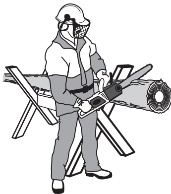
Рисунок 12. Схема розпилювання колоди із використанням козел.
