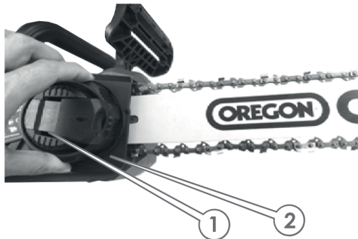
Рисунок 6. Схема регулювання натяжіння.
