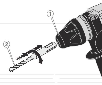
1. Почистіть хвостовик свердла (піки, долото) від пилу та бруду. Змастіть хвостовик тонким шаром мастила.
