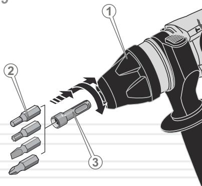
1. Почистіть хвостовик тримача біти стандарту SDS-plus (3) від пилу та бруду. Змастіть хвостовик тонким шаром мастила.
