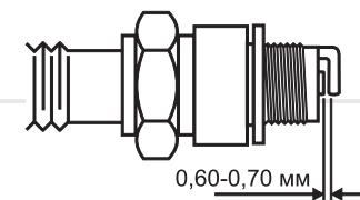
Необходимо регулярно чистить и проверять работоспособность свечи зажигания. Неисправна, грязная или имеющая нагар свеча зажигания становится причиной тяжелого запуска и плохой работы двигателя мотобура.
