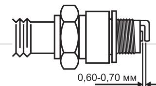
Необхідно регулярно очищувати свічку запалювання та перевіряти її працездатність. Несправна чи брудна свічка запалювання, або свічка запалювання, яка має нагар, стає причиною утрудненого запуску та поганої роботи двигуна мотобура.
