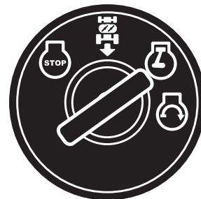
Після запуску двигуна дайте ключу запалювання повернутися в положенні «УВІМК.» і натисніть на регулятор швидкості до потрібної потужності. Для скошування використовуйте повну потужність.
