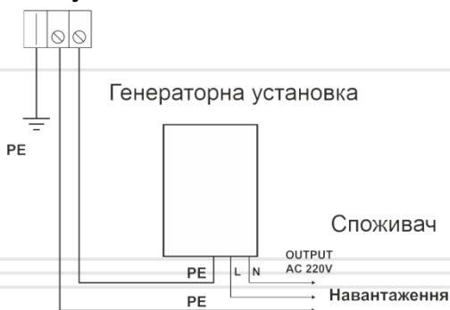
Рисунок 3. Типова схема заземлення.
