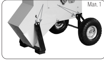
Кріплення опорної ніжки
