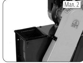
Прилаштування прокладки бункера
