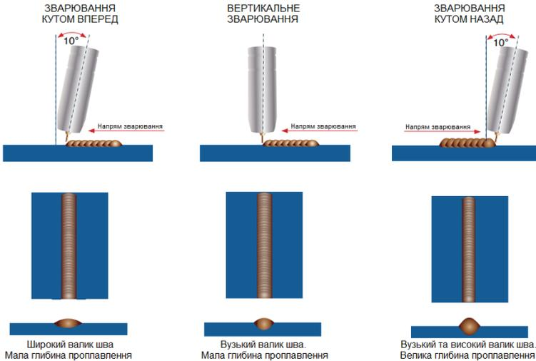
**Зварювання кутом вперед** застосовується для з'єднання тонкого металу, при цьому досягається менша глибина проплавлення, зварний шов більш широкий, зварювання відбувається з більшою швидкістю завдяки спеціальному розподіленню тепла.
