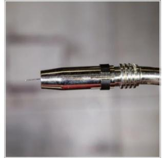
**Виліт електродного дроту** - довжина нерозплавленого дроту, що виступає з кінця контактної наконечника. Значення вильоту електроду в межах 5-10мм, забезпечує стійке горіння дуги, відмінне проплавлення металу та формування шва. Занадто малий виліт - призведе до нестабільного горіння дуги, перегріву контактної наконечника. Занадто великий виліт - велике розбризкування металу, нестабільність горіння дуги, погане проплавлення.
