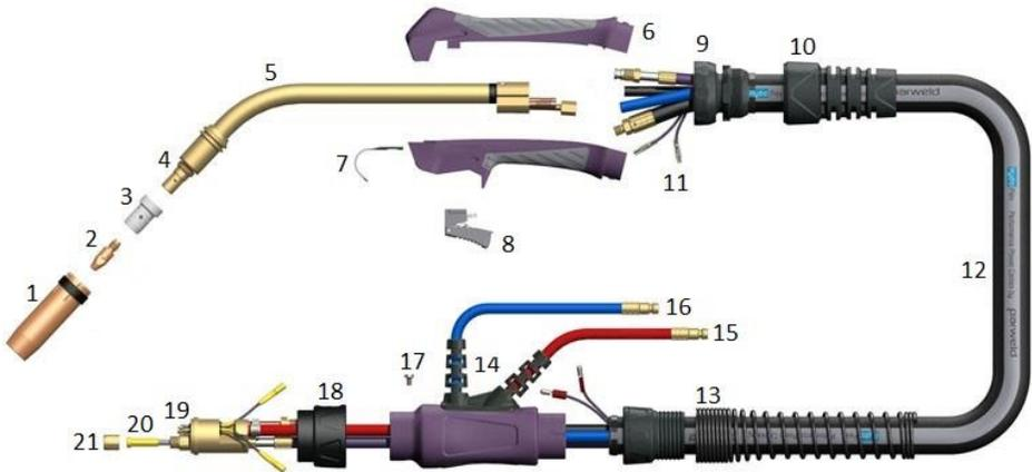
Зварювальний MIG/MAG пальник складається з трьох основних вузлів: центральний роз'єм KZ-2 для підключення до зварювального апарату; шланговий пакет, котрий містить у собі дроти керування, силовий кабель, направляючу спіраль електродного дроту та шланг для підведення газового захисту; робоча частина пальника. Зазвичай шланговий пакет для напівавтомату має довжину від 2,5 до 5 метрів.
