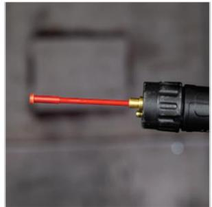
**Порядок проведення монтажу направляючого тефлонового** або поліамідного каналу дещо схожий з процесом монтажу спірального каналу, але має декілька відмінностей:
