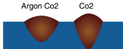
**98%Ar + 2%CO<sub>2</sub>** – рекомендована для промислового зварювання корозійно стійких сплавів (нержавійки), забезпечує задовільне розтікання розплавленого металу;
