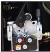
Встановіть ролик з відповідним розміром та типом канавки, який відповідає діаметру отвору контактного наконечника пальника, діаметру та виду електродного дроту.
