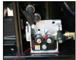
Подайте електродний дрід на привідний ролик таким чином, щоб дрід виходив за межі випускного отвору на 150-200мм. Зафіксуйте дрід прижимним роликом.
