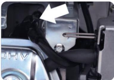
Свеча зажигания: эквивалент TORCH F6TC.
